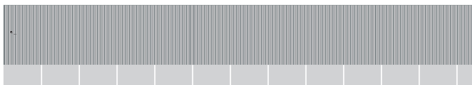
Palissade anti-affiche, H 2,2m, RAL 7046 relief, pas de 9,3 cm - sur chasse roue
